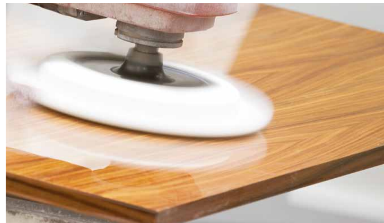
Die Hochglanzpolitur erfolgt ebenfalls in Handarbeit mit Liebe zum Detail für ein perfektes Ergebnis. Polishing the surface to achieve a high-gloss finish is also done by hand with the greatest attention to detail for a perfect result.
